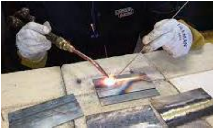
Soldadura Oxiacetilénica (OAW)
